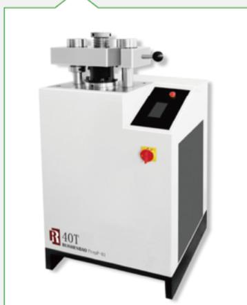
取6g以上样品, 采用20Mpa以上压力将样品制作成压片
