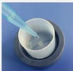
01 用吸管或药匙将1ml以上的样品装入到样品杯中
