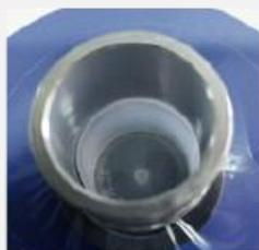
02 通过ESP工具将样品膜固定到样品杯上
