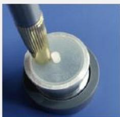
03 倒置样品杯，并通过打孔笔在样品杯底部打1-2个小孔
