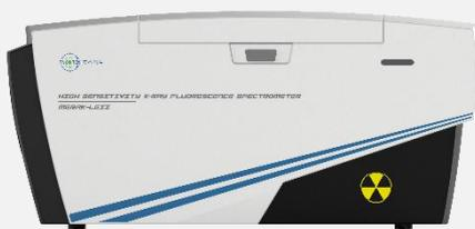
汽柴油中若含有过高的硅会导致汽车氧气传感器失效，甚至损坏发动机，石油炼化企业和成品汽柴油流通销售企业需要控制和检测硅含量。新国 VI 车用汽油产品标准中限制硅含量为 2.0mg/kg，ICP 方法分析硅，硅的形态不同，离子化效率不同，含量受到硅形态的影响。石化行业制订了《NB/SH/T 0993-2019 汽油及相关产品中硅含量的测定 单波长色散 X 射线荧光光谱法》，分析范围 3.0-100mg/kg，单波长 X 射线荧光光谱法操作简单，稳定可靠，是理想的分析微量硅含量的仪器。
