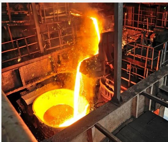
矿渣是高炉冶炼过程中的副产品，主要由  $\text{CaO}$ 、 $\text{SiO}_2$ 、 $\text{Al}_2\text{O}_3$ 、 $\text{MgO}$ 、 $\text{MnO}$ 、 $\text{Fe}_2\text{O}_3$  等氧化物和少量硫化物组成。做为固废类型的一种，其中的有害元素如 S、Cl、Cr、As、Pb、Hg、Cd 等含量受到管控，由于矿渣种类繁多，基体复杂，一种快速、准确、适应性广的元素含量检测方法受到越来越多的关注。
